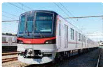
アルミ合金製の軽量車体
